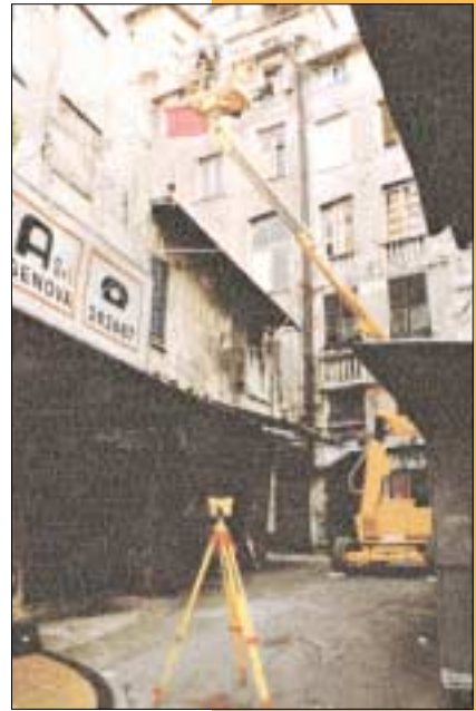
Nelle foto: Piazza dei Truogoli di Santa Brigida, Vico Tacconi e Piazza S. Elena nelle fasi della campagna di rilevamento topografico e fotogrammetrico. Nei disegni: restituzione fotogrammetrica del prospetto su Piazza S. Elena e di Vico Tacconi e di Piazza dei Truogoli di S. Brigida.
