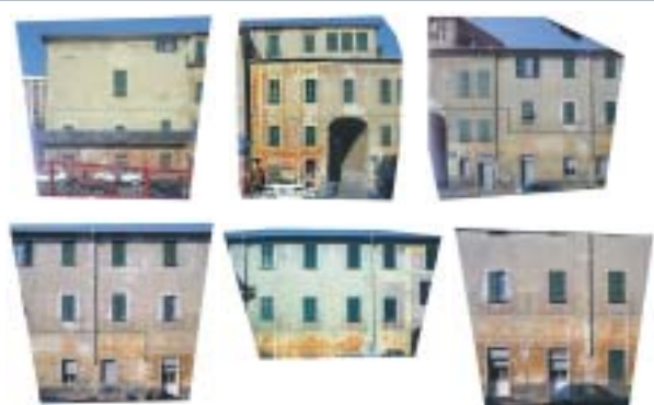
2. I singoli fotogrammi raddrizzati per ridurre le distorsioni prospettiche.
