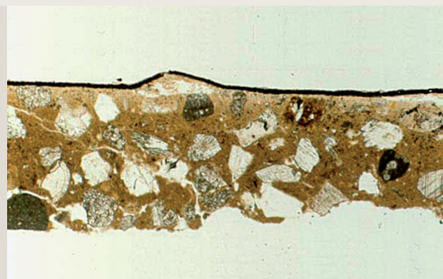
Sezione sottile: è visibile la spinta dei solfati, possibile causa di esfoliazioni, sulla pellicola pittorica.
