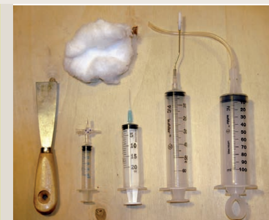
Alcuni strumenti utili nelle diverse fasi operative. Da destra: siringhe graduate in plastica di diversa capacità dotate di aghi, prolunghe e raccordi, cotone idrofilo, spatola.
